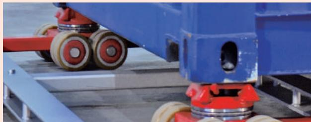
Sistem „Weld-on Cone” pentru Seria K (vezi pag. 18-19, 22-24, 29 pentru detalii tehnice)
